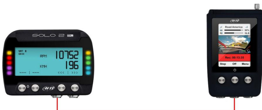
Para conectar o Solo 2 DL ao LCU-One, PODE conectar o conector Binder de 5 pinos localizado na parte inferior esquerda do Solo 2 DL ao conector Binder de 5 pinos do LCU-One, conforme mostrado aqui abaixo.
