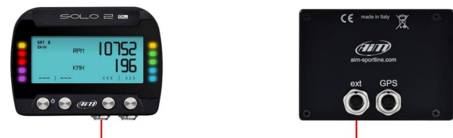
Para conectar o Solo 2 DL ao SmartyCam GP HD, use o cabo SmartyCam CAN e conecte o conector Binder de 5 pinos localizado na parte inferior esquerda do Solo 2 DL ao conector Binder central de 7 pinos da SmartyCam HD como mostrado aqui abaixo.
