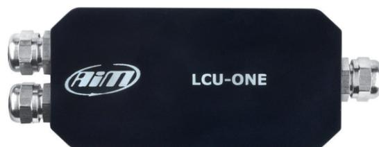
LCU-One CAN se comunica com MyChron5 via CAN, fornecendo valor lambda, relação ar / combustível, temperatura da sonda e parâmetros de diagnóstico. É necessária uma bateria externa de 12 V, que fornecerá energia a todo o sistema AiM, incluindo MyChron5 e qualquer outro AiM
