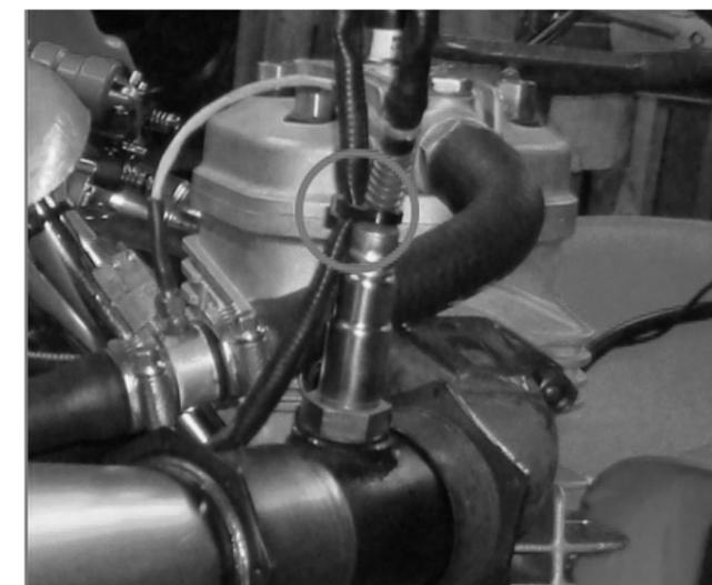
O ângulo de instalação da sonda não deve ser menor que 10 graus, conforme imagem à direita, para evitar que a condensação entre em contato com a sonda, poluindo-a. Incliná-lo em direção ao motorista pode possivelmente salvá-lo de colisões traseiras.
