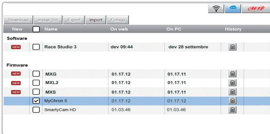
Depois de baixar o firmware MyChron5, você precisa conectar seu MyChron5 ao seu PC via Wi-Fi para executar a função Firmup.
