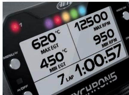
Existem dois LEDs de alarme RGB: você pode configurar a cor, a frequência piscando e o evento para o qual os conectar.
